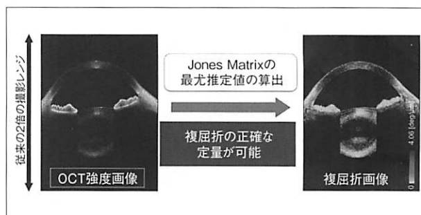
図 3 本機で撮影した正常眼の前眼部 (口絵参照) 複屈折値を疑似カラーマップとして表している。従来の PS-OCT と比較して撮影レンジが 2 倍になり、強膜の撮影がより容易になった。
